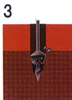
固い地層に達し、回転時の反発が著しく大きな場合
